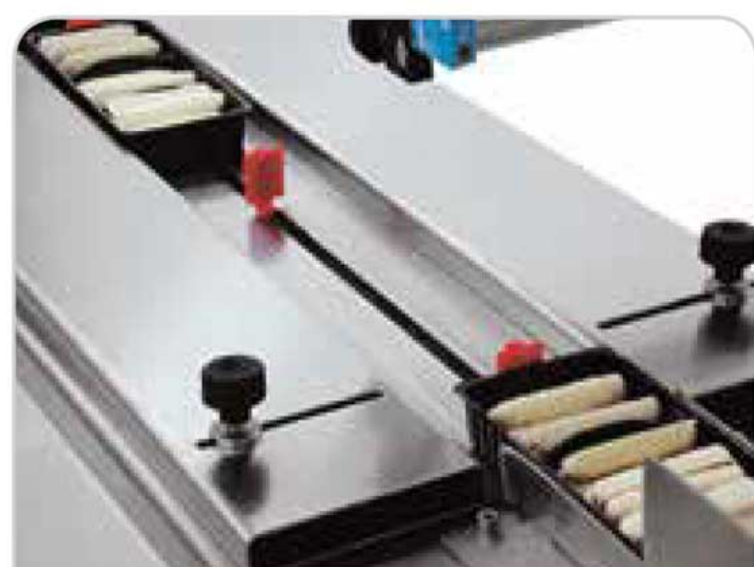
Fotocélula función "No producto-No bolsa"
