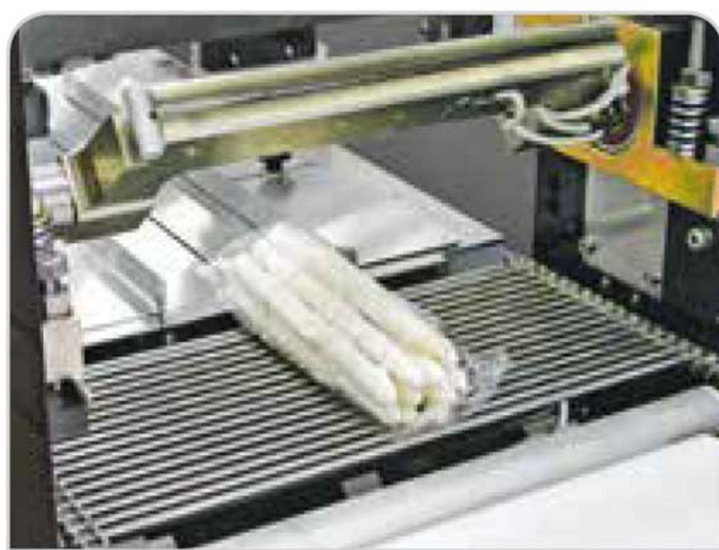
Arrastre motorizado a través de las mordazas y mordaza con hueco
